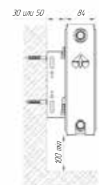
■ рисунок 2 - Крепление к стене радиатора ЛК
